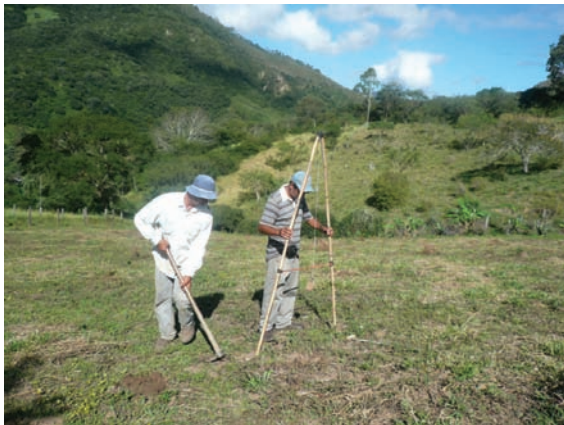
Planificación y diseño de la unidad en curvas a nivel, utilizando el instrumento nivel en "A"
