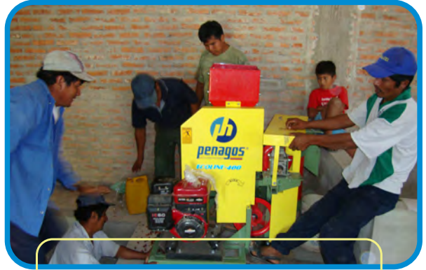
Instalación de máquina despulpadora con motor en la sede de la asociación APAFECH. 2009
