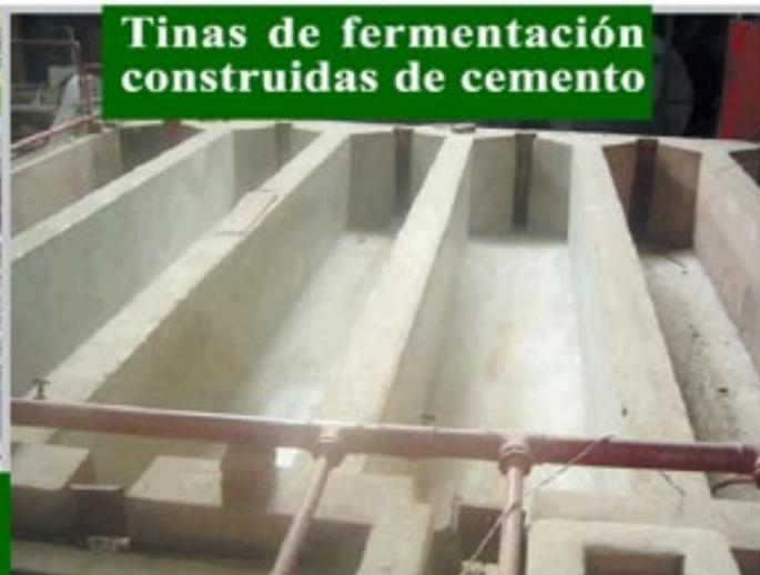
**Tinas de fermentación construidas de cemento**
